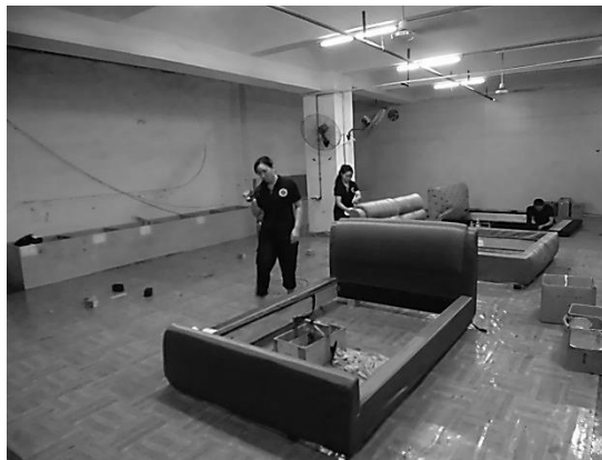
完成品を一度組み立てて、異常がないかを目視で検品する。最新テクノロジーが集約された『T6』（左）と、『T7』（右）。この他、枕選びのための測定器もある。
